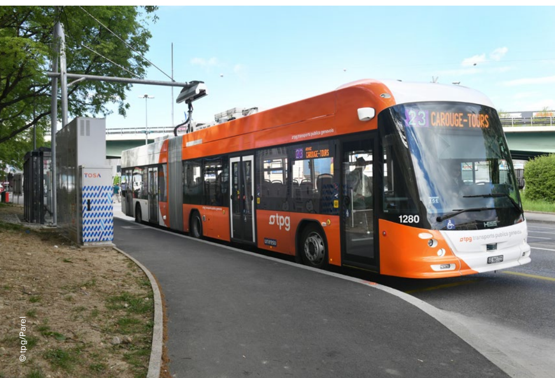
Bus électrique TOSA avec son système de recharge de batterie électrique (Genève).
